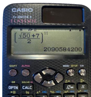
5. ábra: Egy irracionális szám kellően nagy hatványának tizedesei a kijelezhető számjegyeken túlra esnek, így egész számnak tűnnek.
